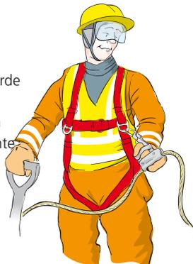
El trabajador puede ajustar la longitud del cabo de seguridad usando una argolla de ajuste.
