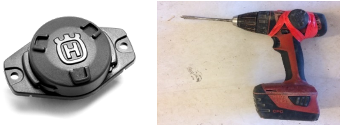
Figur 6. Maskinsensor (t.v.) och maskinsensor fastsatt på en bormaskin (t.h.)
