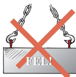
Lyftkrokar anbringas med öppningen utåt
