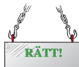
Lyftkrokar anbringas med öppningen utåt
