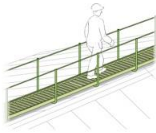
Figur 31b. Gångbrygga närmare taknock än 1,0 meter. Skyddsräcke på båda sidor, alternativt använda PFU.
