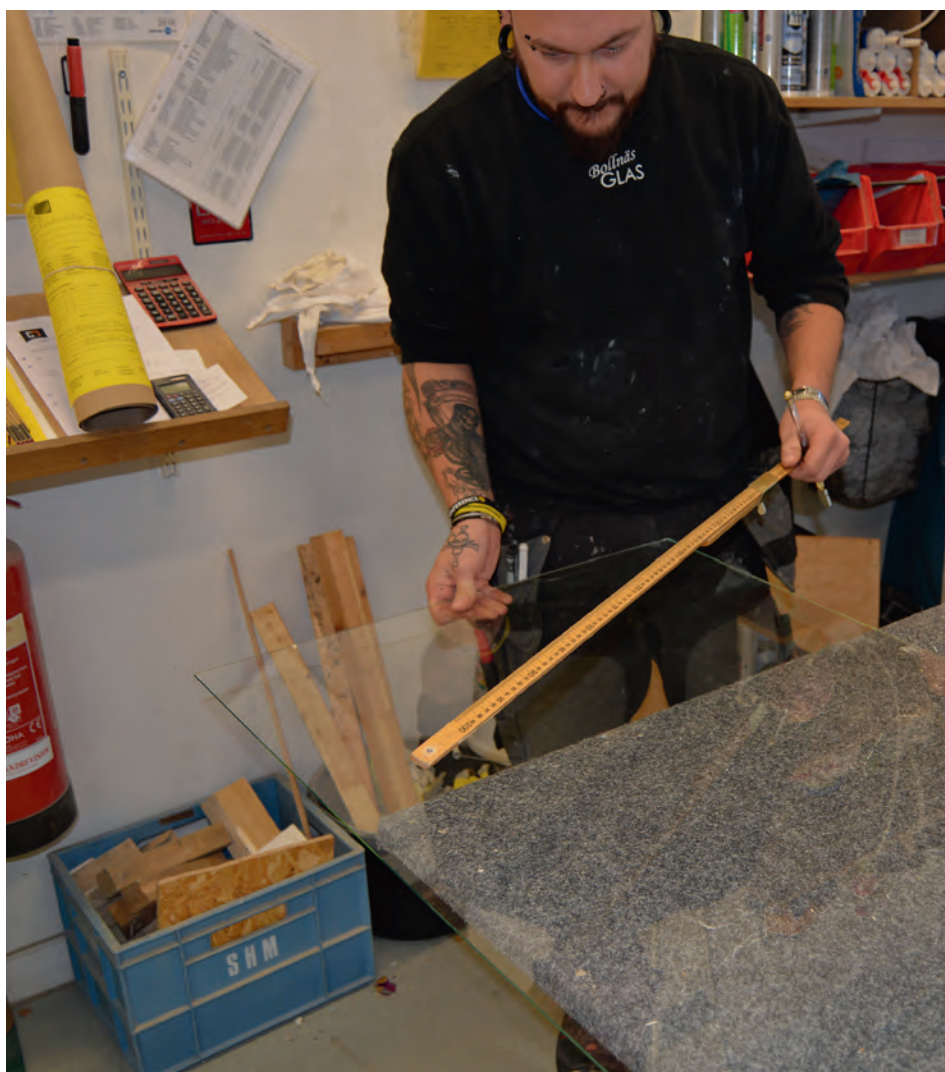
Tobias Fryksell skär till ett glas till de nyrenoverade fönstren.
